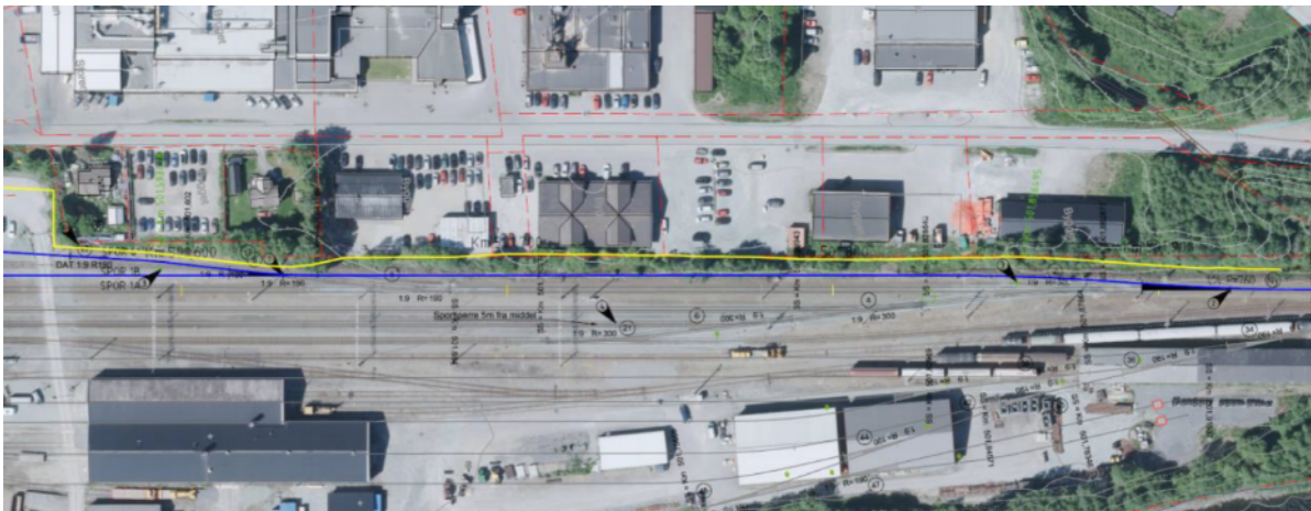
Figur 22 Gul linje markerer mulig skråningsutslag mot eiendommer langs Bygget.
